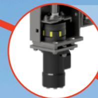
Doppelabgang mit Gummidüse zur Regulierung des Systemdruckes
